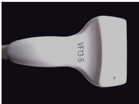
**Abbildung 1: Der verwendete Linear Array Schallkopf VF 13 – 5**
